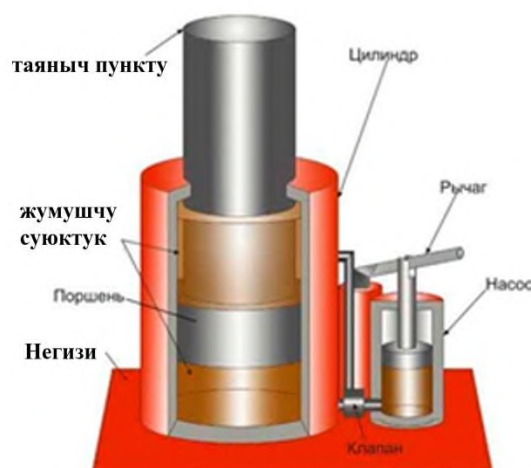
3-сүрөт. Гидравликалык домкрат
