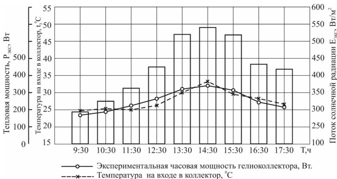
Рисунок 7 – Зависимости температуры на входе в коллектор [ t_3=f(T) ], потока солнечной радиации [ E_{экс}=f(T) ] и тепловой мощности [ P_{экс}=f(T) ] от времени нагрева T
