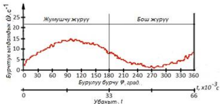
11 – сүрөт. Аспаптын бурчтук ылдамдыгынын эксперименталдык диаграммасы
