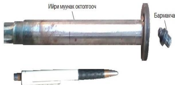
13 – сүрөт. Перфоратордун ийри муунак октолгоочунун сынышы
