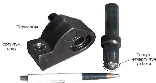
12-сүрөт. Перфоратордун термелгичинин жана толкун өткөргүчүнүн сынышы
