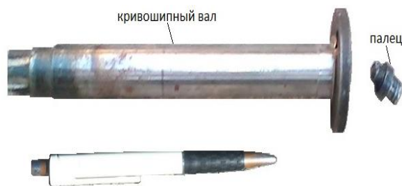
Рисунок 13 - Поломка кривошипного вала перфоратора
