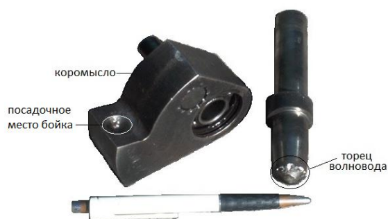
Рисунок 12 - Поломки коромысла и волновода опытного образца перфоратора
