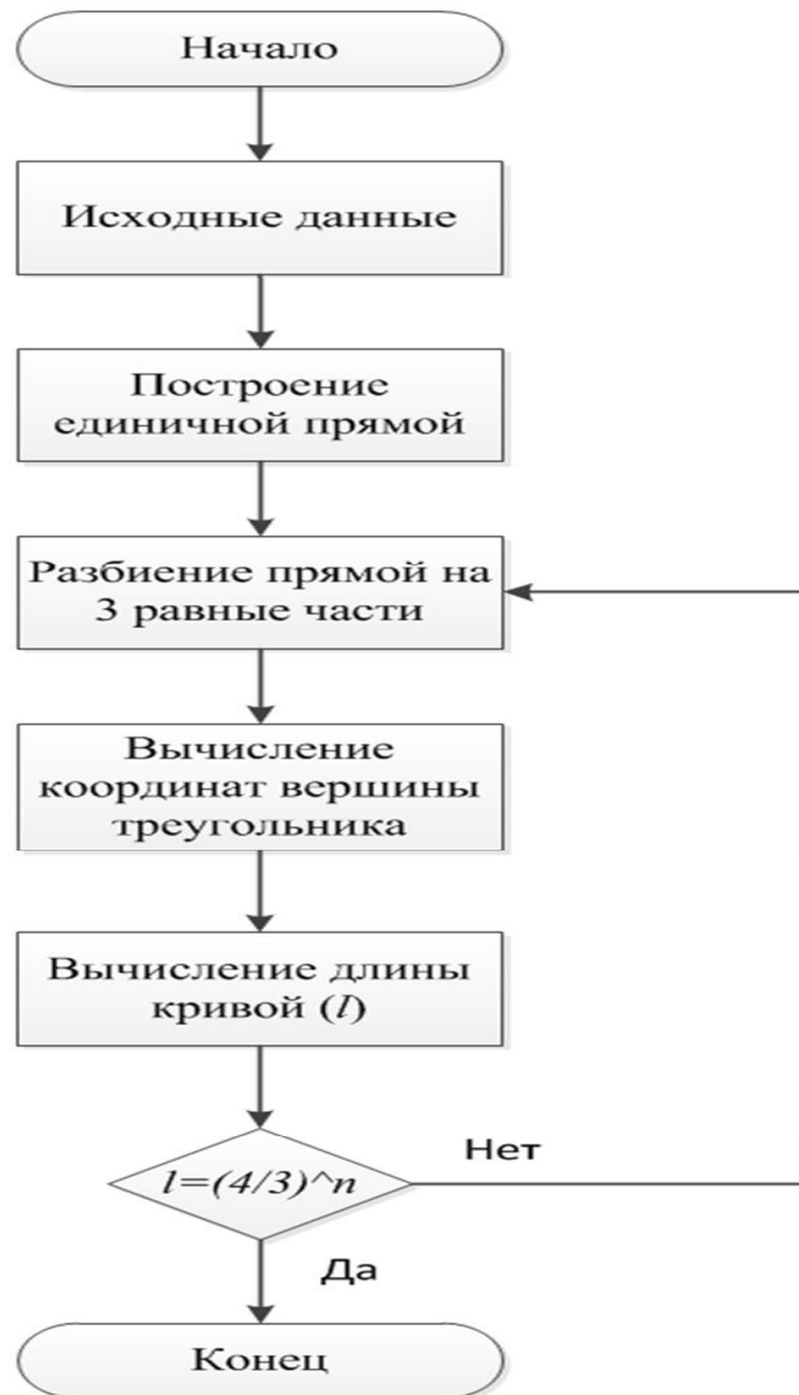
Рис.1. Алгоритм построения кривой Коха.
