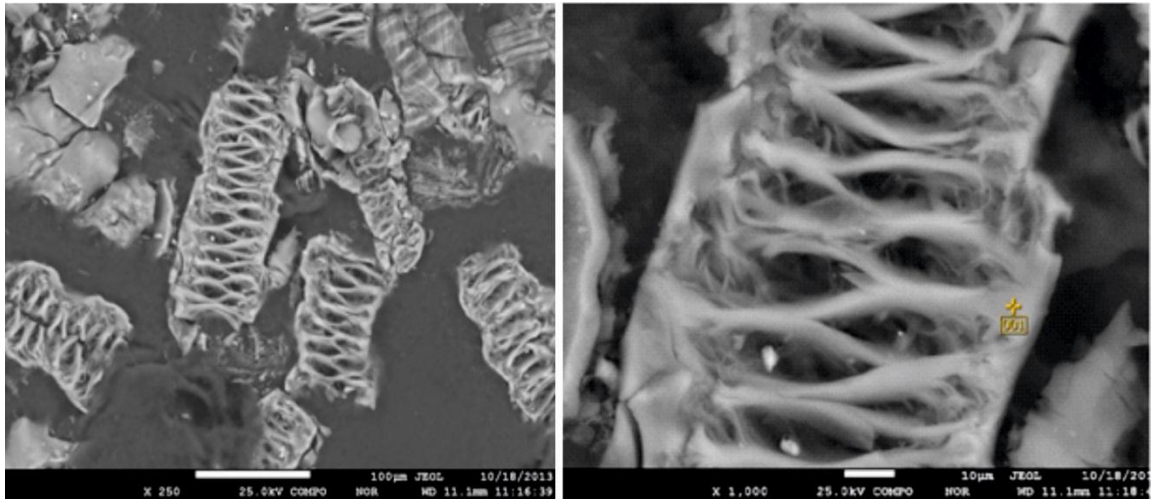
8-сүрөт. Аморфтук кремнийдин кош кычкылынын СЭМ микрофотографиясы.
