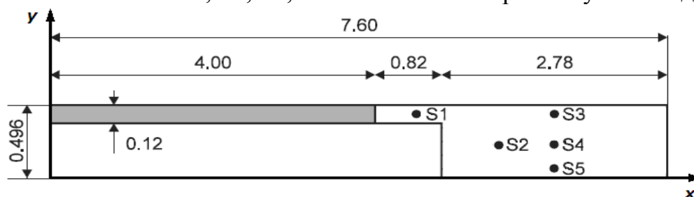
Рис. 38. Геометрия канала и расположение измерительных датчиков.
