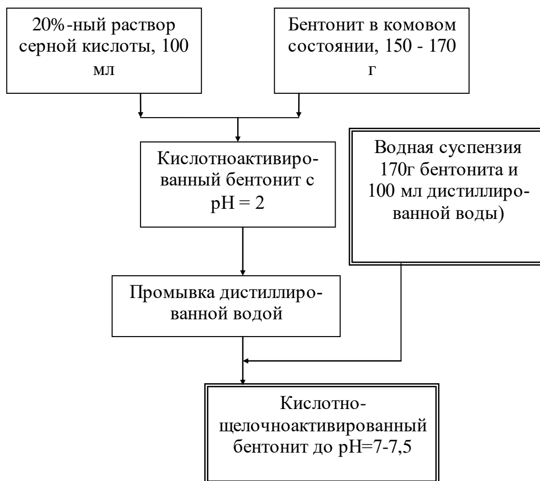
Рис. 2 – Технологическая схема приготовления кислотно-щелочноактивированного сорбента
