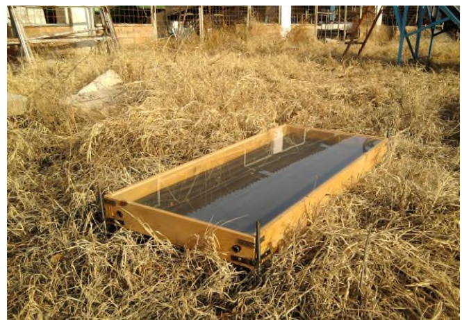
б) коллектор на грунте
