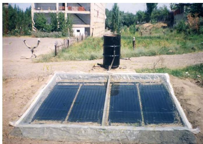
б) натурное испытание солнечной водонагревательной установки
