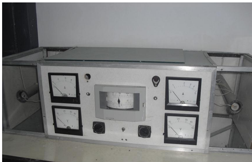
Рисунок 3.11 - Схема лабораторной установки для определения коэффициента теплопроводности
