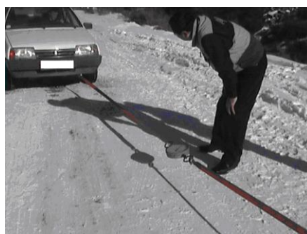
Рисунок 4.21 - Определение тяговых усилий на ледяной поверхности дороги с «насажанными» каменистыми частицами
