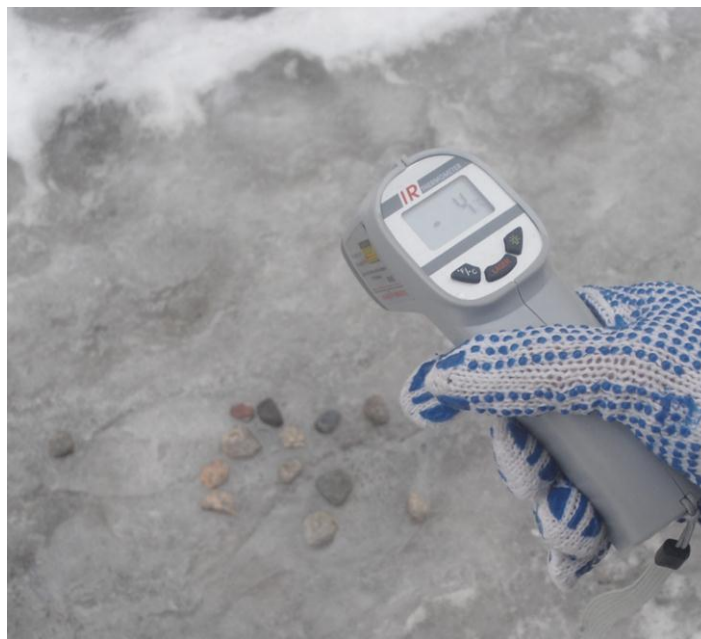
Рисунок 4.9 - Измерение температуры ледяной поверхности горной дороги
