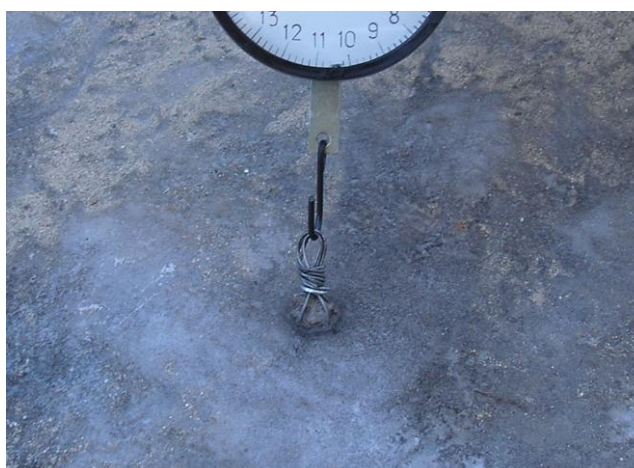
Рисунок 4.18 - Подъем каменистой частицы, замороженной в ледяном массиве
