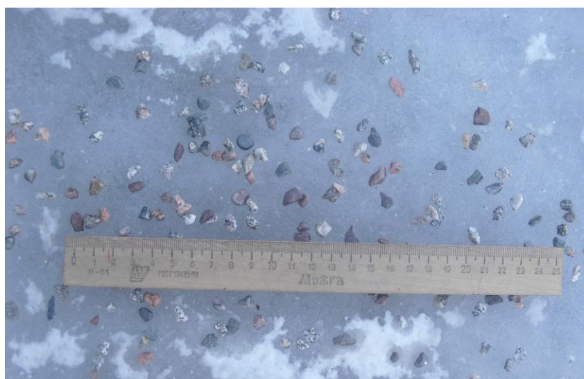
Рисунок 4.8 - Каменистые частицы, замороженные в ледяном массиве
