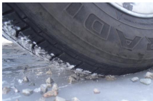
Рисунок 9 - Взаимодействие пневматического колеса транспортного средства с ледяным покрытием с каменистой шероховатостью, образованной замороженными каменистыми частицами
