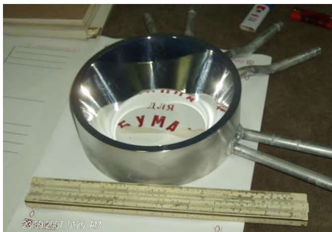
Рис.14. Общий вид вторичного конического концентратора БСП после сборки.
