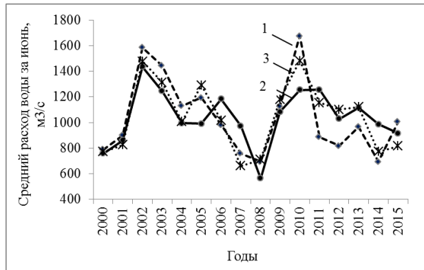
Рис. 4.14. График хода расходов воды, притекающего в Токтогульское вдхр. на июнь (1) фактического и спрогнозированных по уравнениям 2.11 (2) и 2.13 (3).
