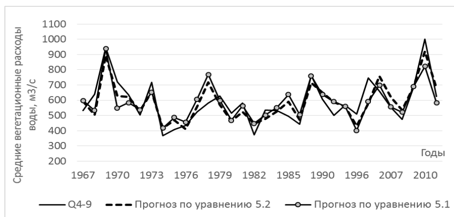
Рис. 2.6. Зависимости для прогноза среднего вегетационного расхода воды, рассчитанные по уравнению 2.8 и 2.8.
