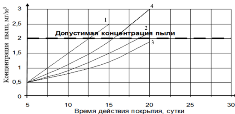
Рисунок 4.8. Эффективность обеспыливания поливом автодорог [по данным автора]: 1 – первичная обработка асфальтового покрытия; 2 – первичная обработка щебеночного покрытия; 3 – повторная обработка асфальтового покрытия; 4 – повторная обработка щебеночного покрытия.
