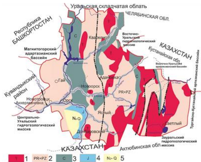
Рисунок 5.2 – Гидрогеологические массивы, сложенные варисскими гранитами и гранитогнейсами с повышенными концентрациями (до 10 ПДК и больше) радона и токсичных продуктов его распада, и гидрогеологические бассейны Восточного Оренбуржья.
