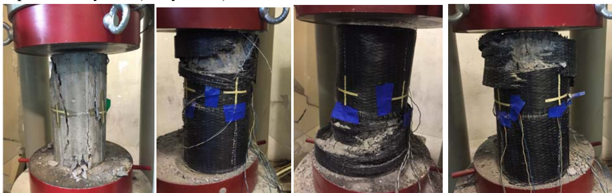
Рисунок 1 – Вид разрушенных образцов серии К-15 без усиления, с усилением 1-им, 2-мя и 3-мя слоями сеток обоймы
