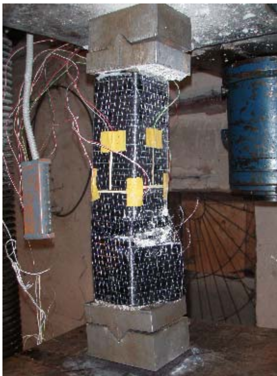
Рисунок 7. Разрушение усиленного сетками образца при внецентренном сжатии
