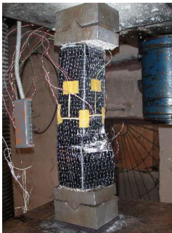
Рисунок 4.11. Разрушение усиленного сетками образца при внецентренном сжатии
