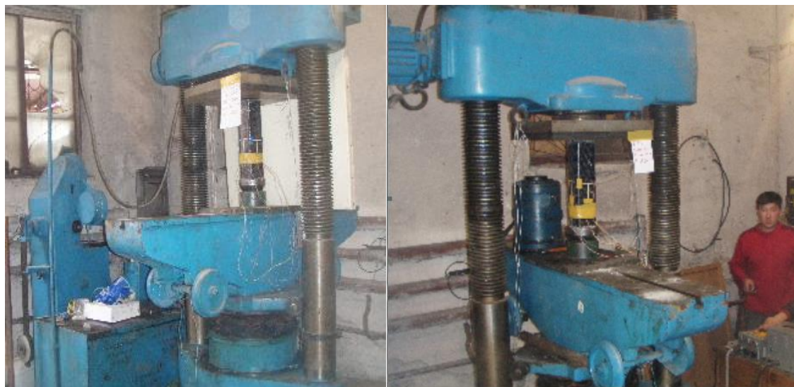
Рис. 4.1. Общий вид испытания бетонной призмы на осевое сжатие на гидравлическом прессе ИПС-250
