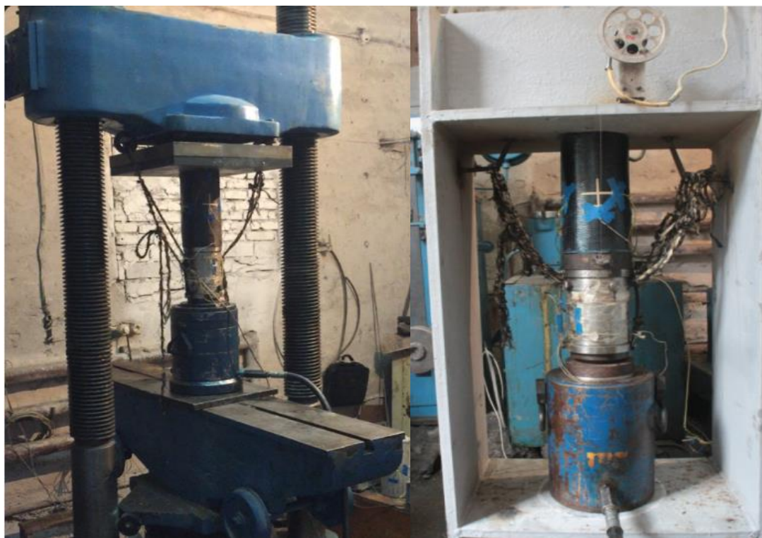
Рис. 2.1. Общий вид испытания усиленных образцов на осевое сжатие на гидравлических прессах ALPHA 3-3000S и ИПС-200
