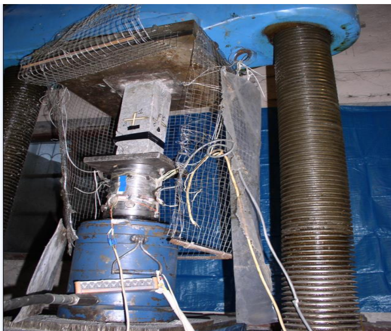
Рис. 4.17 - Динамические испытания бетонных призм на осевое сжатие
