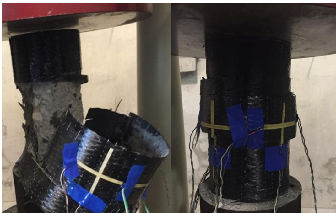
Рис. 3.6. Характер разрушения образцов серий К10-2 и К10-3
