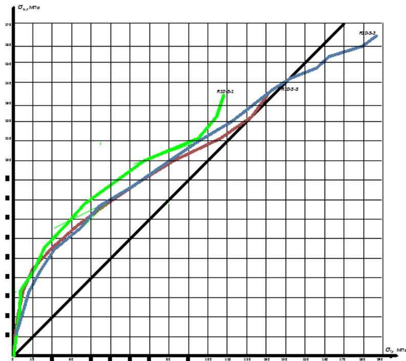
Рис. 3.10. Соотношение сжимающих напряжений от действия продольной силы и от обжатия обоймой ФАП образцов серии К10-3 (3 слоя сетки)
