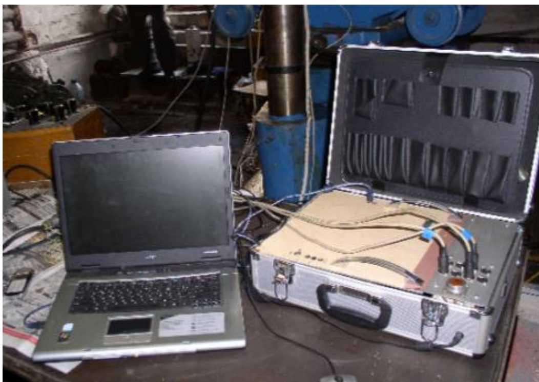
Рис. 2.5. Измерительный комплекс РСМ-8 для регистрации параметров динамических испытаний образцов
