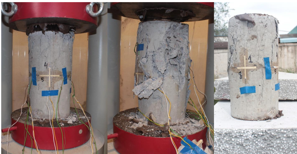
Рисунок 3.39. Общий вид разрушенных образцов серии КП-0
