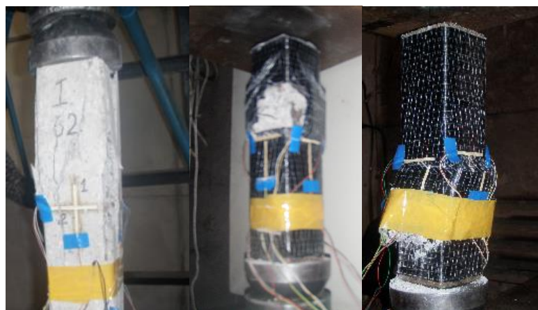
Рисунок 4.3. Характер разрушения призм: не усиленной, усиленной одной и тремя слоями сеток
