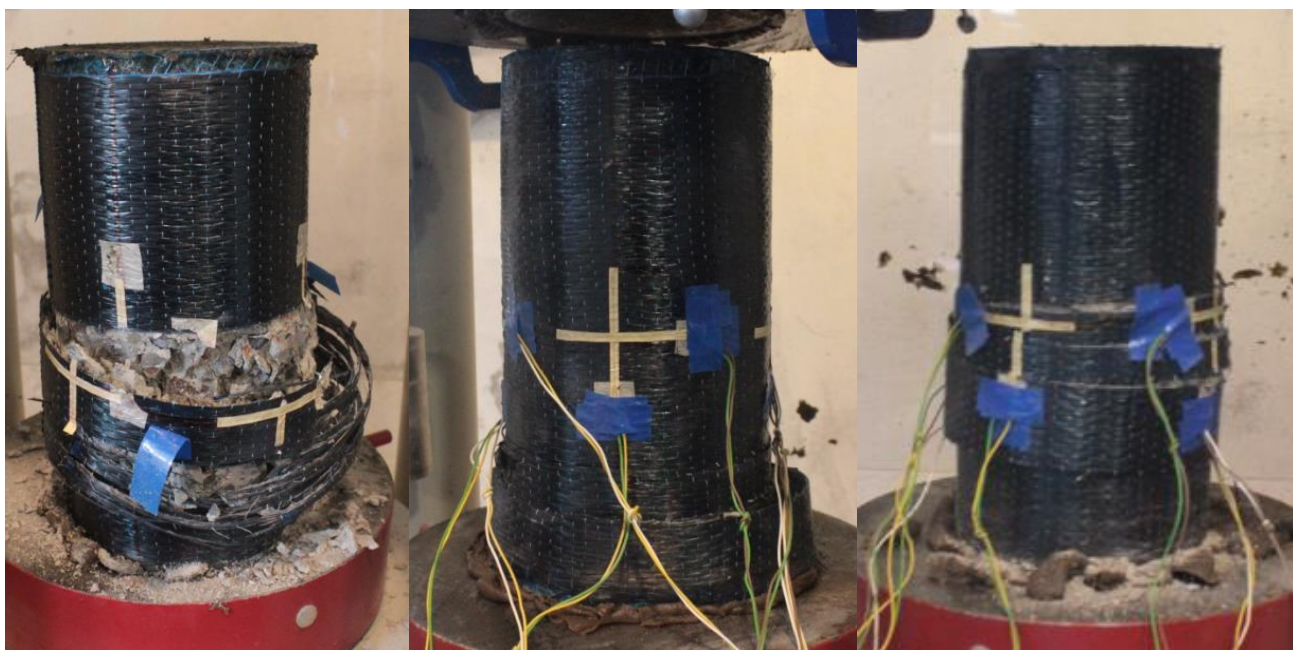
Рис. 3.40. Общий вид разрушенных образцов серии КII-1
