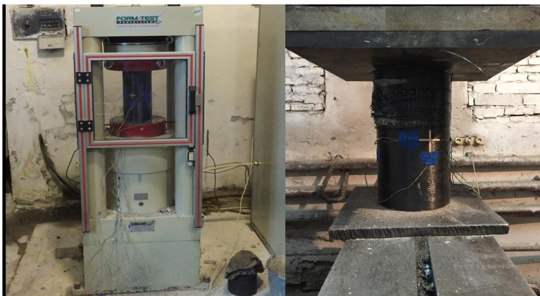
Рис. 2.1. Общий вид испытания усиленных образцов на осевое сжатие на гидравлических прессах ALPHA 3-3000S и ИПС-200
