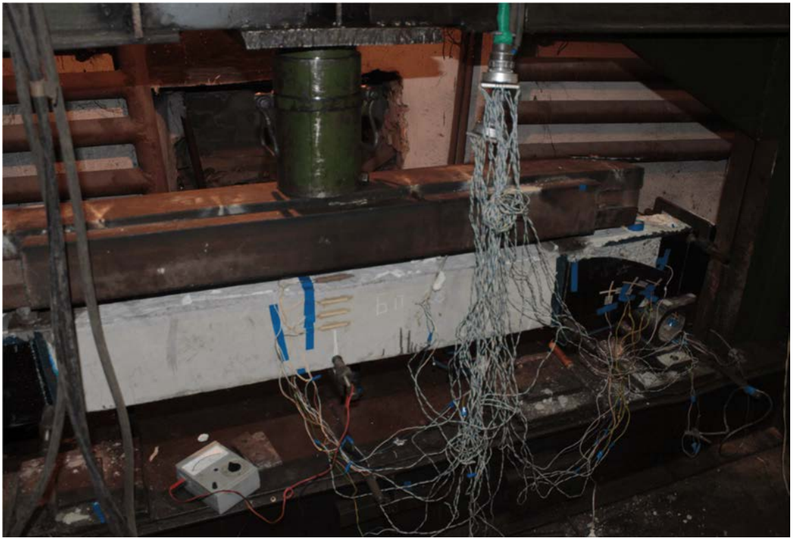
Рис. 3.25. Разрушение опорной зоны балки BQIII-1
