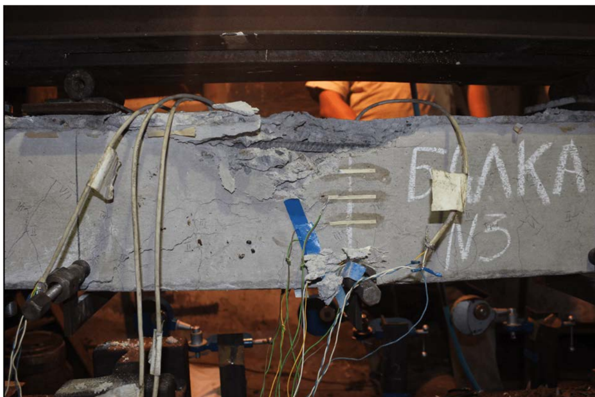
Рис. 3.64. Разрушение балки БШ-3д при динамическом нагружении
