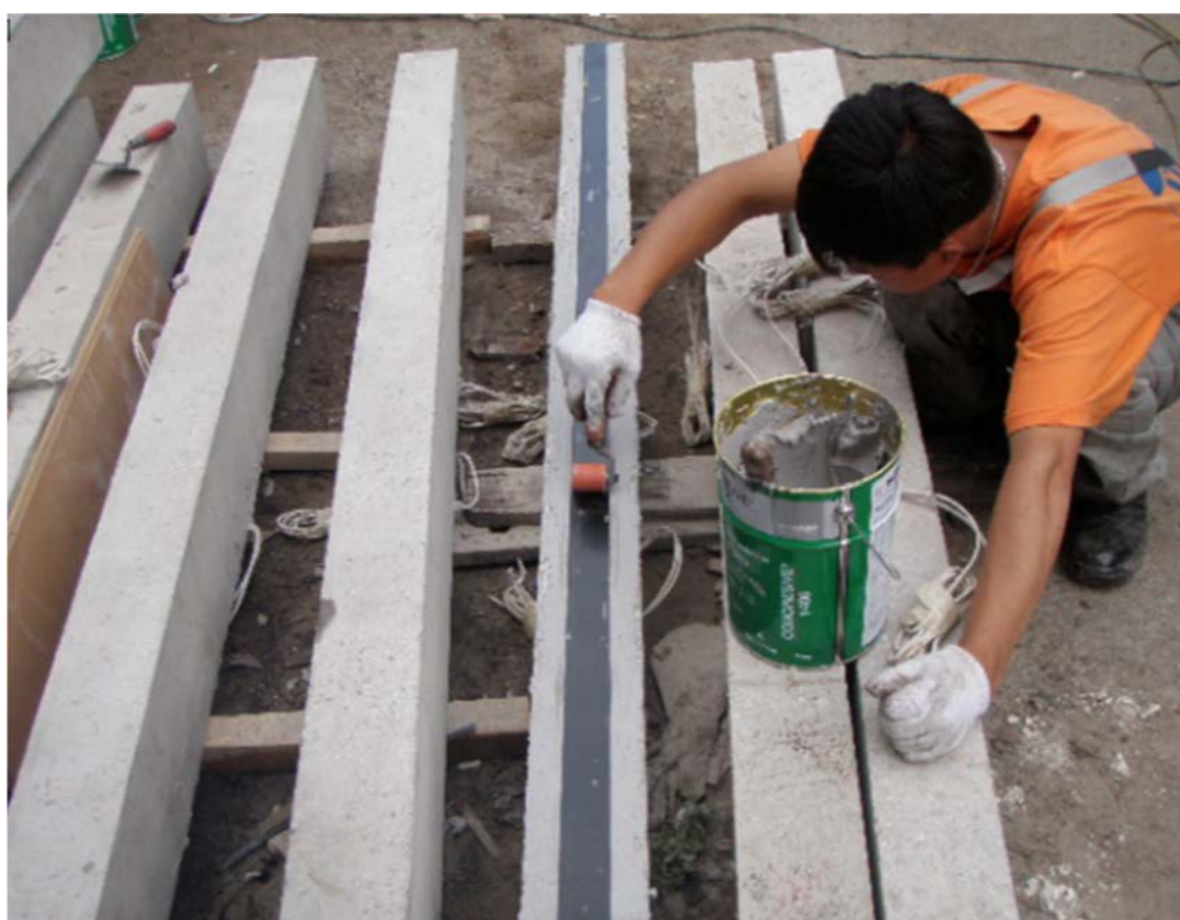
Рис. 2.8. Наклеивание лент ламината на опытные балки
