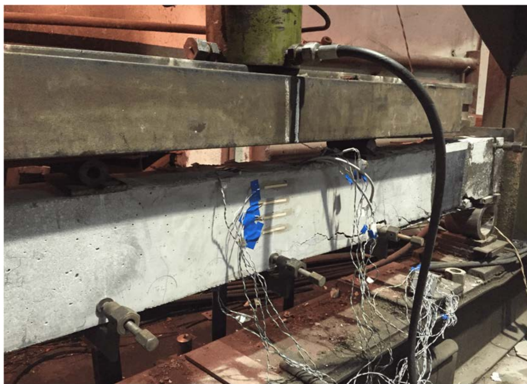
Рис. 3.8б. Разрушение балки БП-1с
