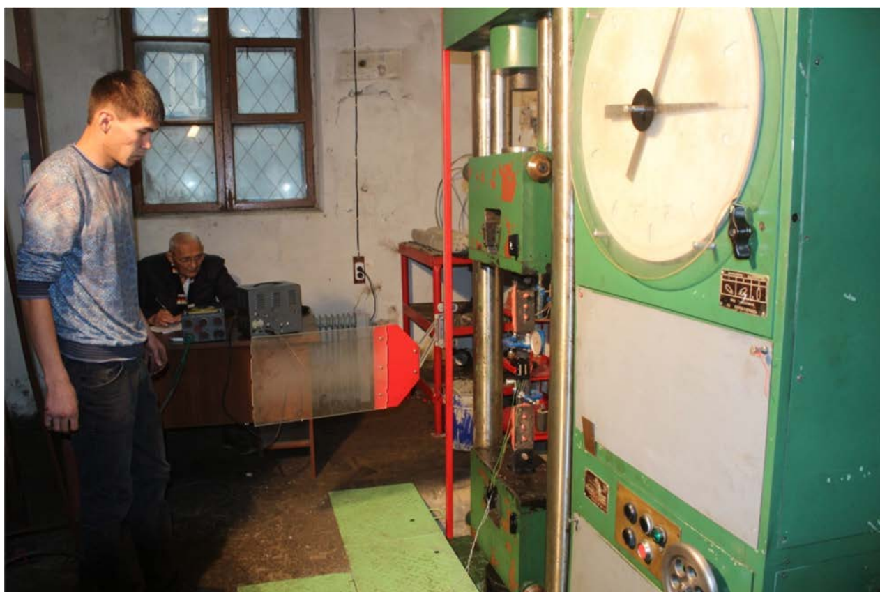
Рис. 2.9. Испытание на растяжение образца ламината в разрывной машине Р-50
