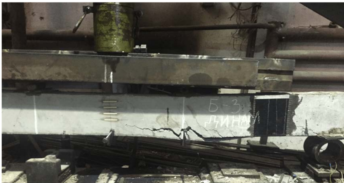
Рис. 3.38. Фрагмент зоны разрушения балки БП-2д при динамическом нагружении
