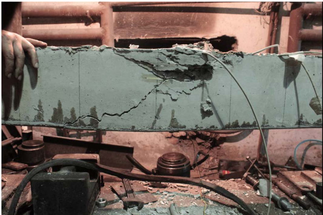
Рис. 3.33. Фрагмент зоны разрушения балки БП-2д при динамическом нагружении
