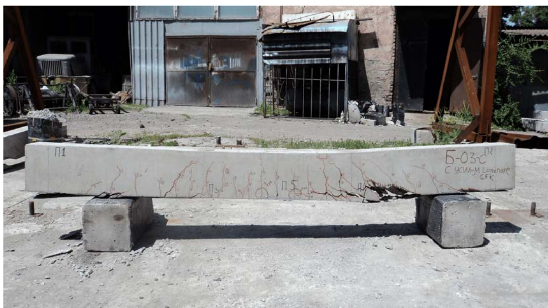
Рис. 3.2. Разрушение балки с усилением ламинатом растянутой зоны
