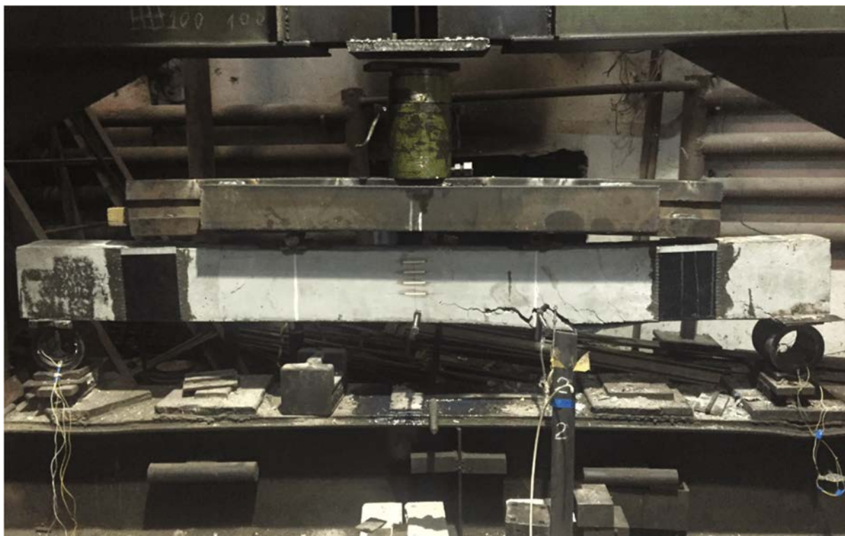
Рис. 2.3. Общий вид динамических испытаний балки
