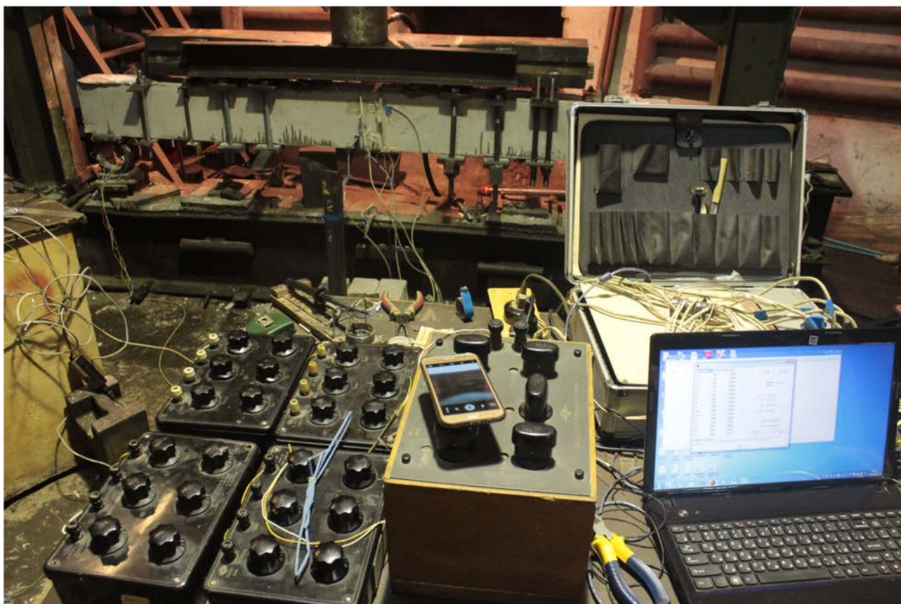
Рис. 2.4. Регистрирующий электронный комплекс ПРИС1000, использованный при динамических испытаниях балок
