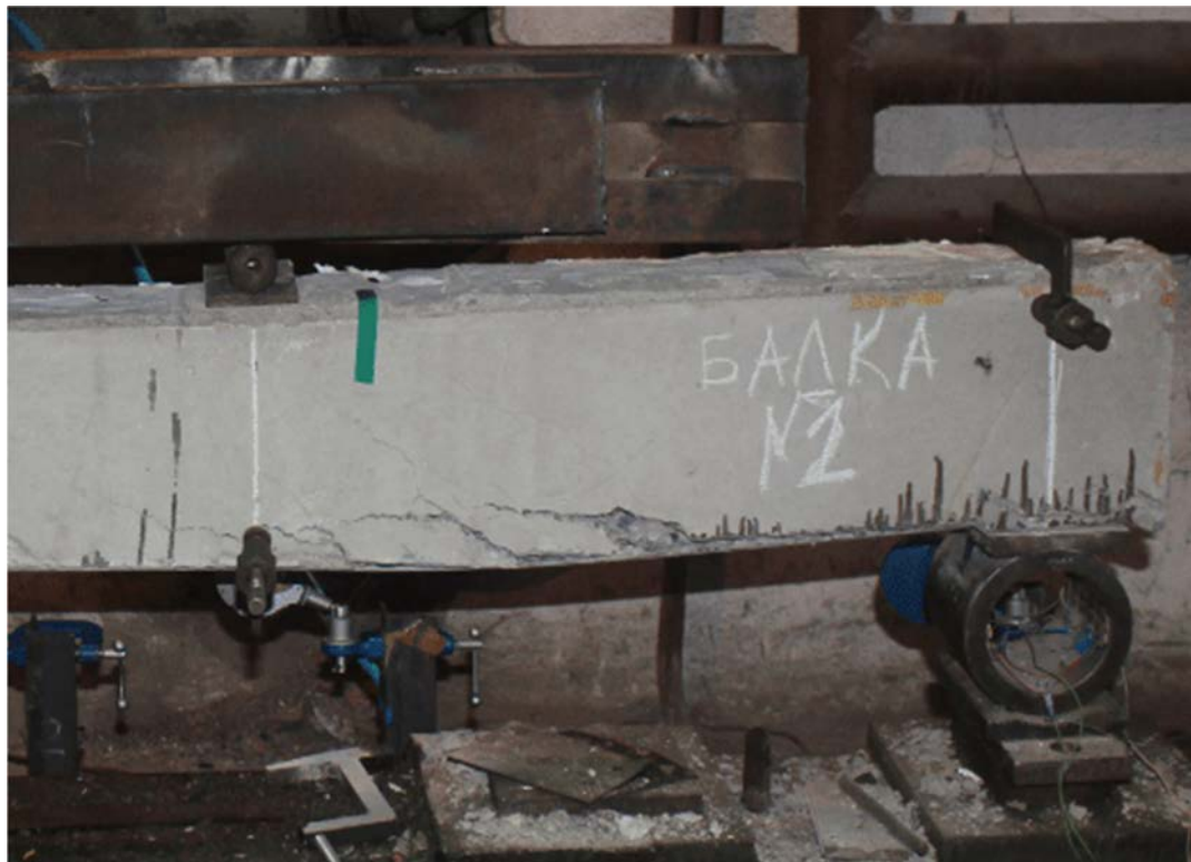
Рис 3.13. Разрушение приопорной зоны балки БШ-1с
