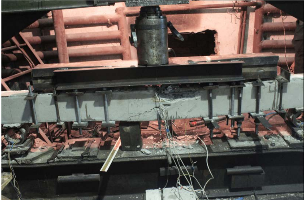
Рис. 3.32. Разрушение балки БП-2д при динамическом нагружении
