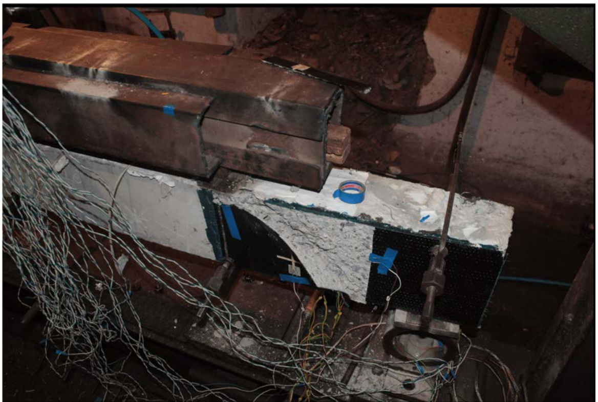
Рис. 3.26. Разрушение опорной зоны балки BQIII-2
