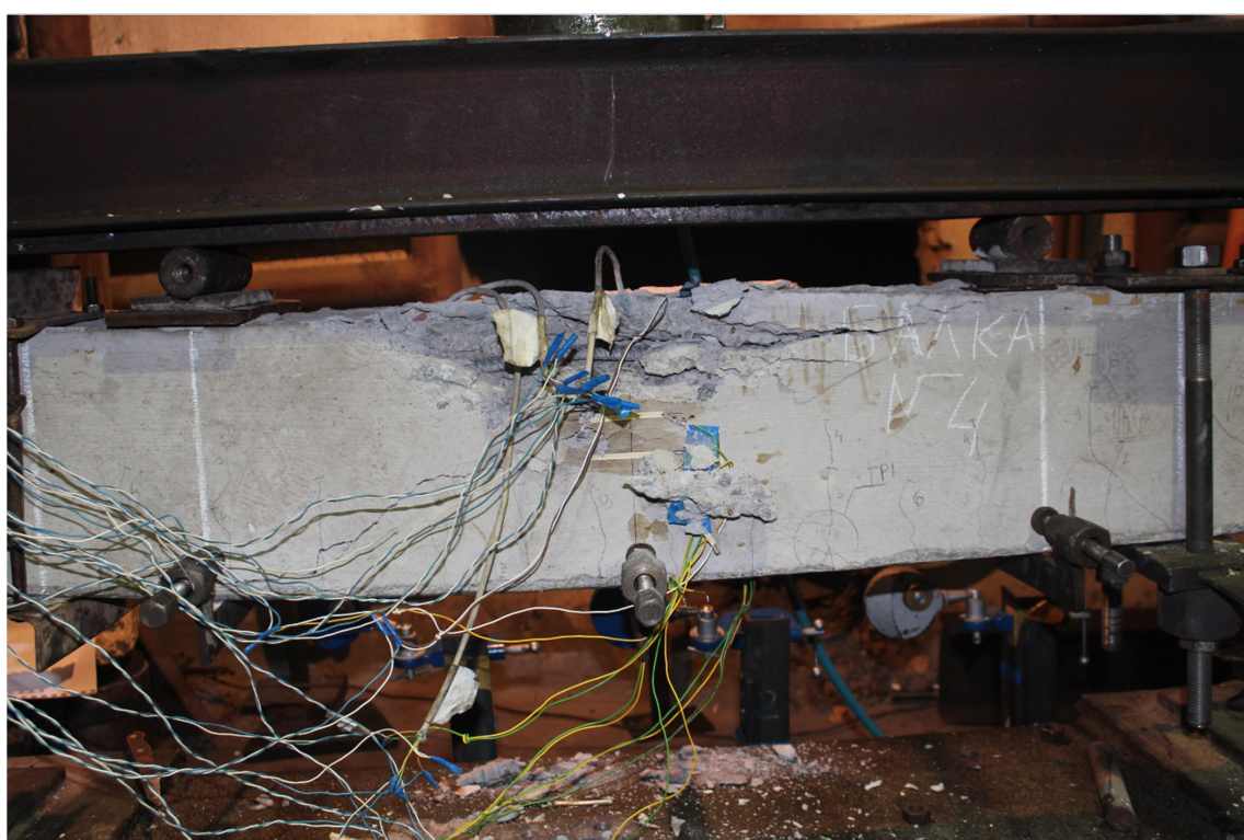
Рис. 11. Разрушение сжатой зоны бетона в зоне чистого изгиба
