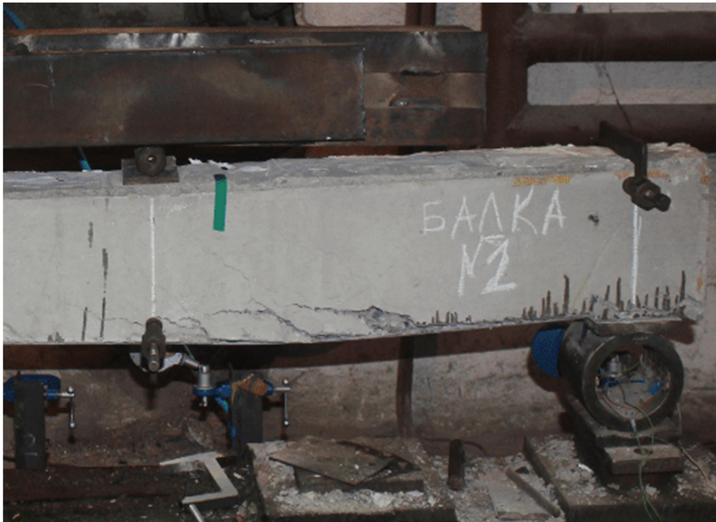
Рис 8. Разрушение приопорной зоны балки БШ-1с
