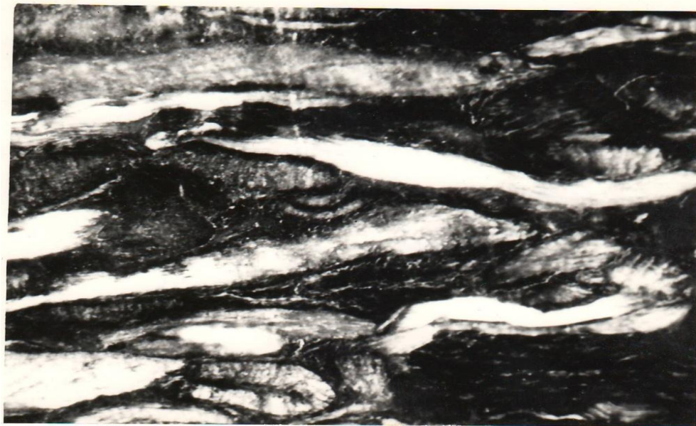
Рисунок 3.7 - Микрофотография шлифа образца арболита с окраской каждого вида наполнителя вдоль ориентации частиц
