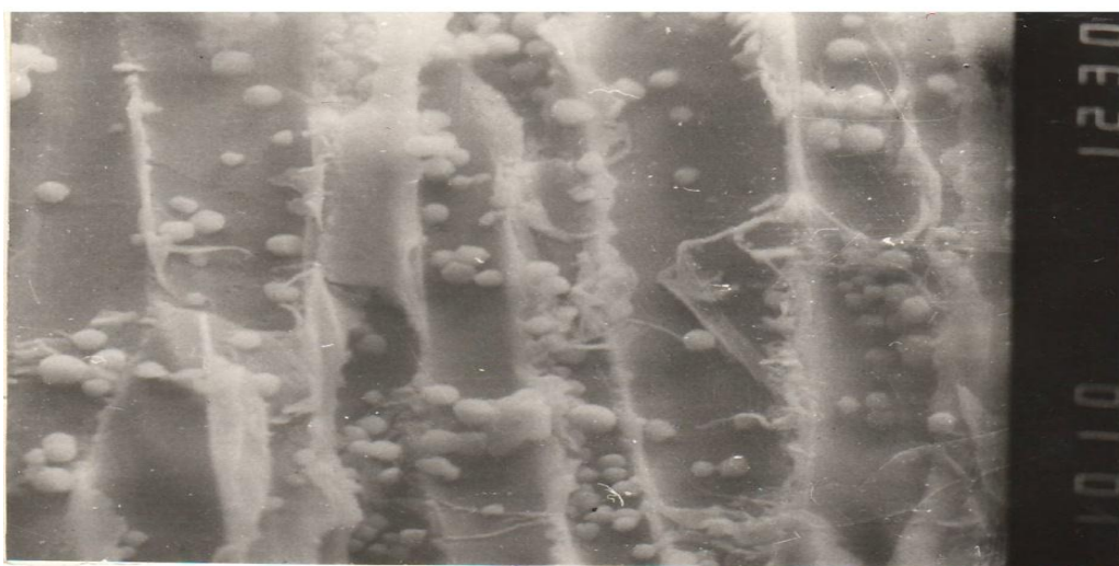
Рисунок 3.12 - Поверхность «среза» образца арболита с мелкими частицами – шариками (увеличена в 1000 раз)
