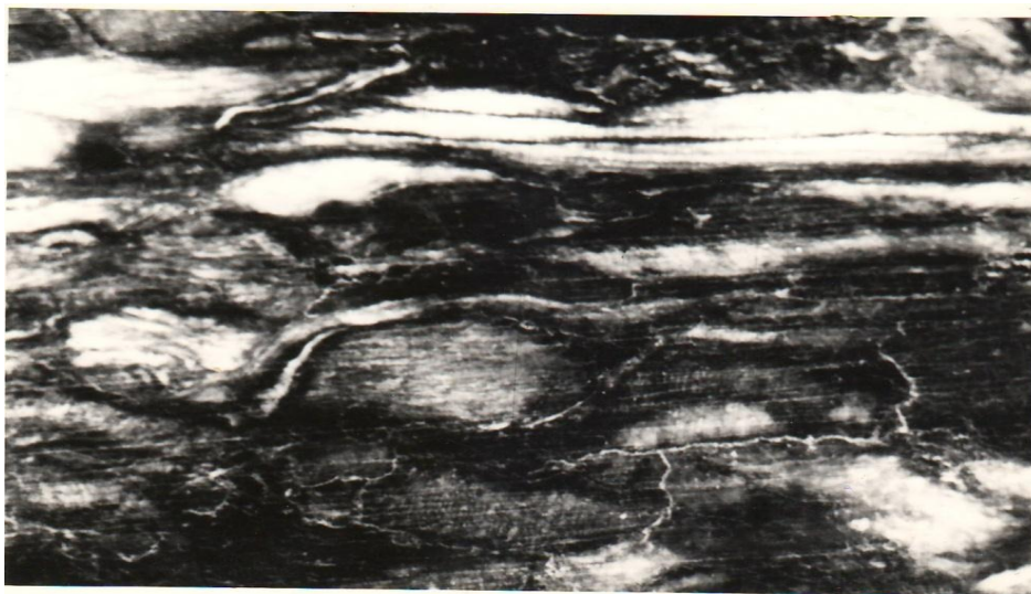
Рисунок 3.6 - Микрофотография шлифа вдоль ориентации частиц наполнителя (увеличена в 300 раз) при содержании фракции:
