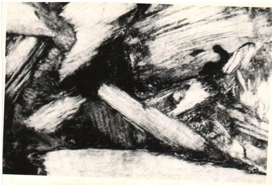
Рисунок 3.8 - Микрофотография шлифа образца арболита с окраской каждого вида наполнителя в поперечном разрезе
