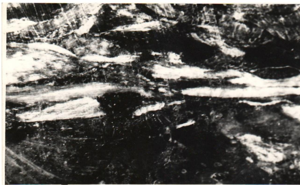
Рисунок 3.5 - Поверхность излома арболита плотностью 650 \text{ кг/м}^3 , травление серебром (увеличена в 300раз)
