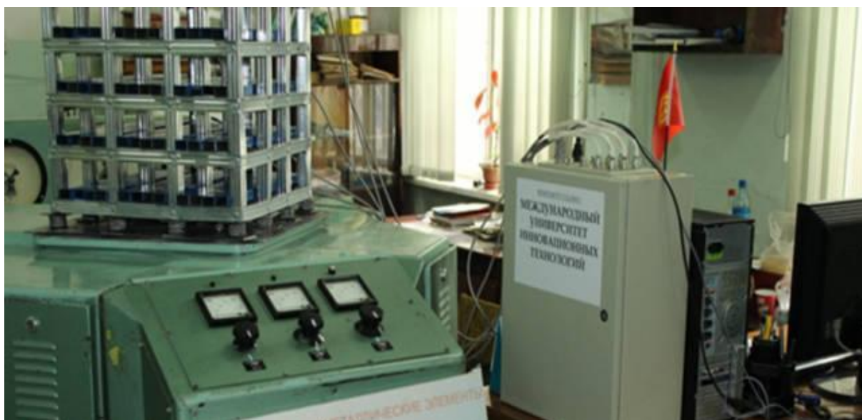
Рисунок 2.24 – Общий вид вибростенда с пультом управления и модуля СТД 2060
