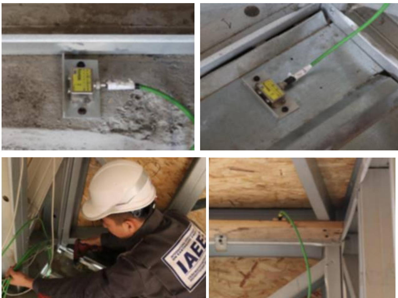
Рисунок 2.29 – Процесс установки датчиков-акселерометров на покрытии платформы, на полу второго этажа и снизу фермы над вторым этажом
