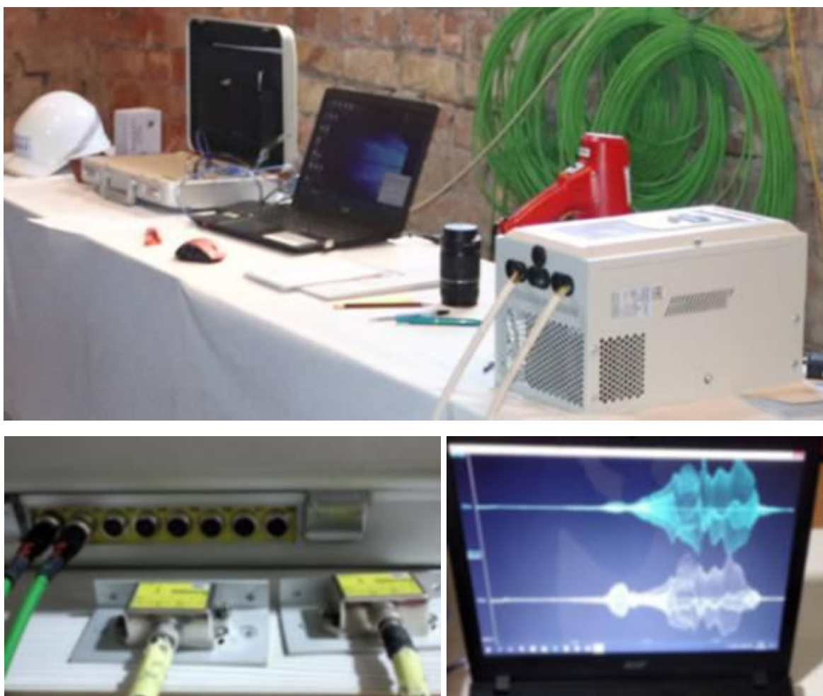
Рисунок 2.26 – Общий вид системы управления и подключения датчиков к регистрирующей аппаратуре. На экране ноутбука показан пример записи
