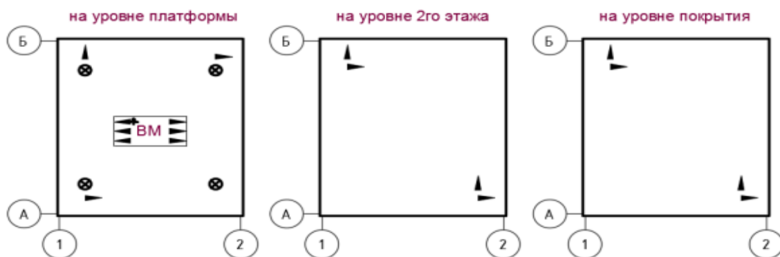
Рисунок 2.28 – Схема расстановки акселерометров (датчиков) при определении параметров микросейсмических колебаний здания.
