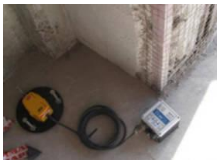
Рисунок 4.2 – Общий вид записывающего устройства. Станция оснащена 24 битным CUBE дигитайзером, подключен к 4,5 Гц геофону (желтый)
