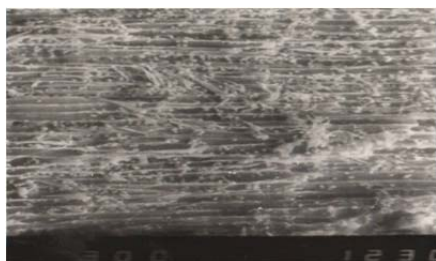
2-сүрөт. Тыгыздыгы 600 \text{ кг/м}^3 , арболиттин кесилген бети, күмүштөлгөн (300 эсе чоңойтулган)
