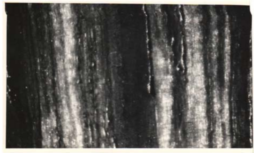
Сүрөт. 5. Арболит үлгүсүнүн бетиндеги "багыттарынын" бөлүкчөлөрүнүн узундук багыт менен (1000 эсеге чоңойтулган)
