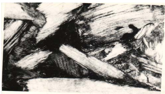
Рисунок 4 - Микрофотография «излома» образца арболита с окраской каждого вида наполнителя в поперечном разрезе
