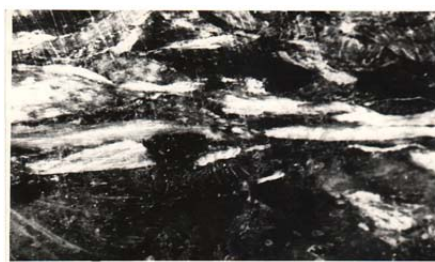
Рисунок 3 - Микрофотография излома протравленная парафином вдоль ориентации частиц наполнителя (увеличена в 300 раз)
