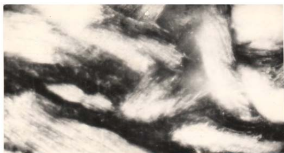
Рисунок 6 - Поверхность «излома» образца арболита с крупными порами между частицами (увеличена в 1000раз)
