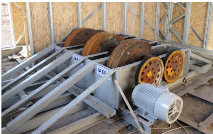
2-сүрөт – Мобилдүү вибромашинанын жалпы көрүнүшү жана акселерометрлерди платформанын үстүнө орнотуу схемасы
